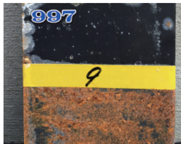
30日間/8倍濃度塩水噴霧結果(鉄板)
