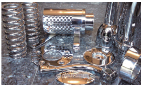
クロムパーツ類への防錆・光沢施工
