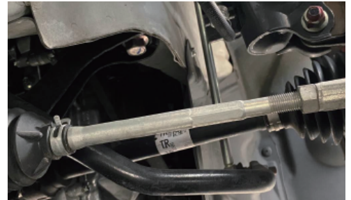
施工後約3年半経過中のフロントブッシュ周りの金属類
