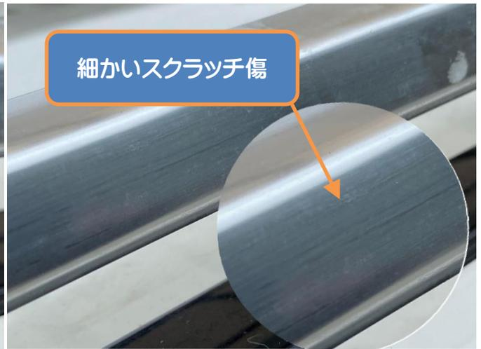
ボトルをよく振り、ウールに滴下し、指先の軽〜い加圧で左右方向に研磨します。
